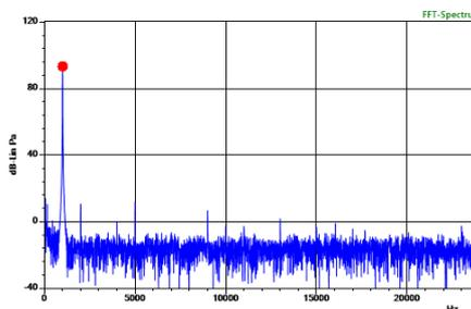
**Max Marker:** Normalerweise beginnt jede Analyse mit der Peak-Suche. Finden Sie einfach mit einem Klick die höchsten Peaks im Spektrum und listen Sie sie in der Cursortabelle auf. So können Sie schnell überprüfen, ob die Werte den kinematischen Frequenzen ähneln.
