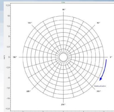
Für die Darstellung der Achsbewegung bietet der NVH Analyzer Pro die Orbit-Diagramm. Die Integration/Doppelintegration kann einfach direkt in der Kanalkonfiguration durchgeführt werden, um die Verschiebung basierend auf dem Beschleunigungsmessereingang zu berechnen. Die Ausgabe des Ordertracking-Moduls kann sowohl für die Anzeige von Einzelaufträgen als auch von zyklischen Durchschnittswerten verwendet werden.
