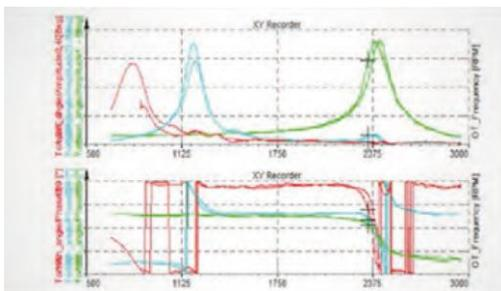
Mit den hochpräzisen Digitalzählern des LTT24-4, basierend auf einer 800-MHz-Zeitbasis, lassen sich Dreh- und Torsionsschwingungswinkel und -geschwindigkeiten (mit zwei Encodern) auch bei hohen Drehzahlen exakt bestimmen. Konstanter Winkel
