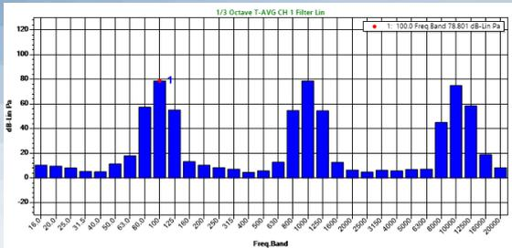
Die konstanten Prozentbandfilter arbeiten in Echtzeit und bieten ein 1/3-Band-Oktavspektrum. Mit der Array-Statistik-Mathematik ist es einfach, Maximal-/Min-/Durchschnittswerte über das gesamte Spektrum oder einen bestimmten Frequenzbereich zu extrahieren.
